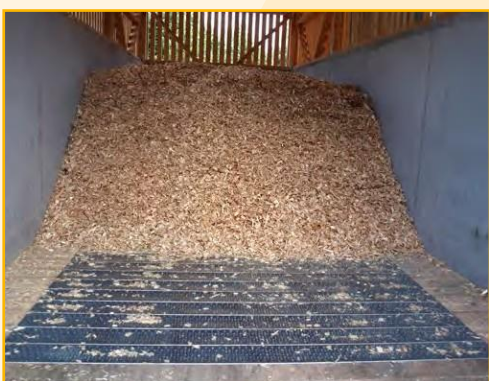
CONA - SYSTEMSKIZZE SOLARE HACKGUTTROCKNUNG - FLACHROST
